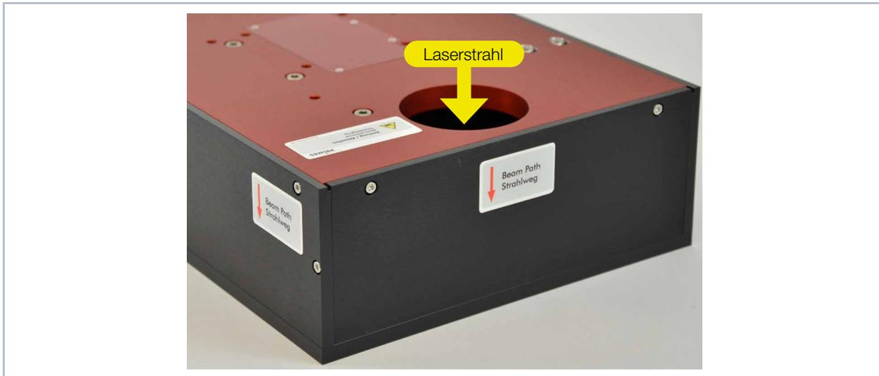
Abb. 4.4: Strahlrichtung am Beispiel des BM+ 60
